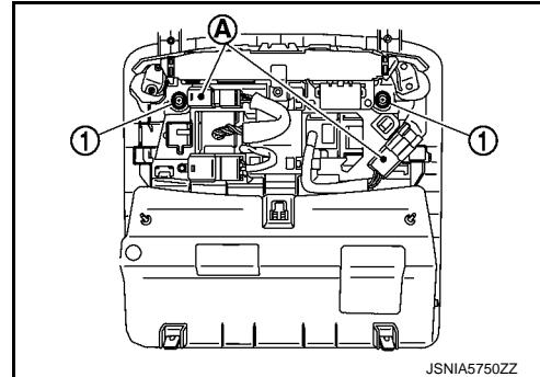
3. 从地图灯总成上将 Telematics 开关 ① 和地图灯总成饰件 ② 一起作为一个单元拆下。
