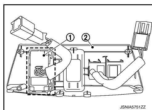
4. 拆下 Telematics 开关 ①，拉伸地图灯总成饰件 ② 的棘爪。
